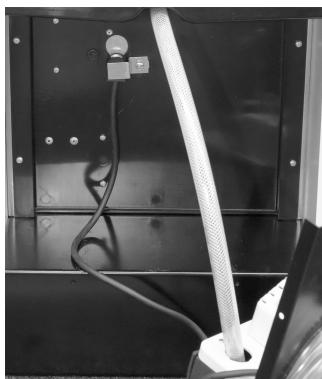
6. Mettez la plaque de montage avec la pompe dans le carter et serrez les 4 vis à tôle.
