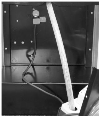
6. Schieben Sie die Montageplatte mit der Pumpe in das Gehäuse und schrauben Sie die 4 Blechschrauben fest.
