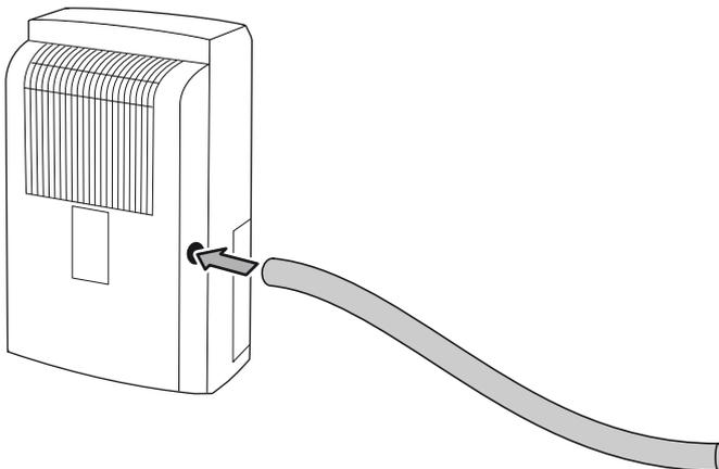
4. Überprüfen Sie, ob der Schlauch richtig auf dem Anschluss sitzt. Korrigieren Sie ggf. die Position über die Öffnung am Kondensatbehälter.
