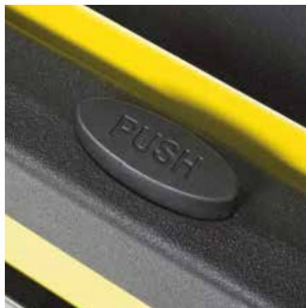
Eenvoudig, praktisch: Voor hoogteverstelling van de telescoop-trekbeugel is een druk op een knop voldoende.
