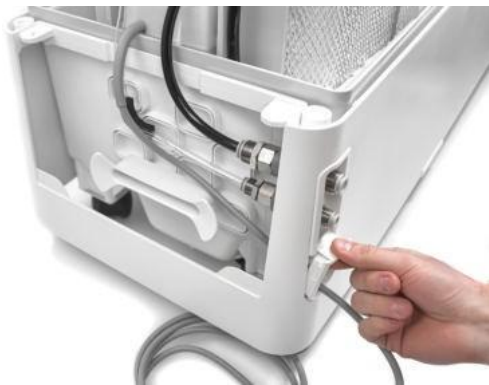
Fig. 6.3.1.3: De zijklep openen
