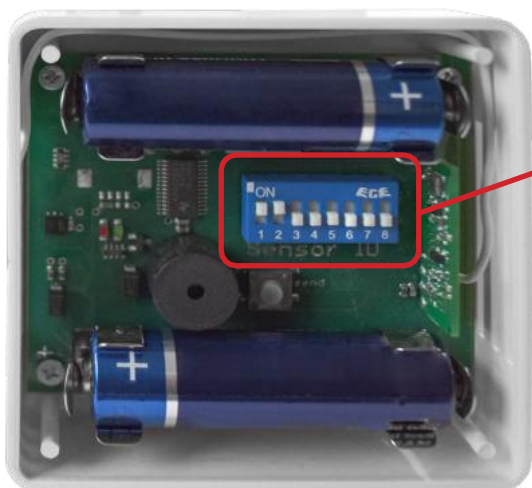
Fig. 5.6.1: Binnenaanzicht van de draadloze vochtzender
