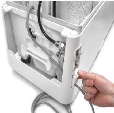
Fig. 7.4.1.1: Verwijderen van het bovenste deel van de behuizing
