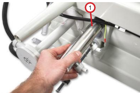
Fig. 8.1.2.5: De UV-sterilisatiebehuizing verwijderen
