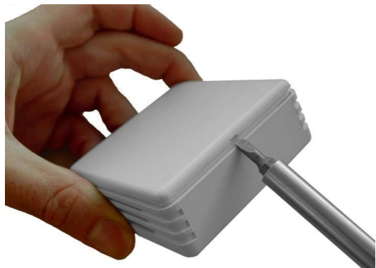
Fig. 3.4.1: De afdekking openen
